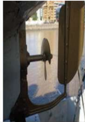
Esquema de un timón actual en una nave a motor.
